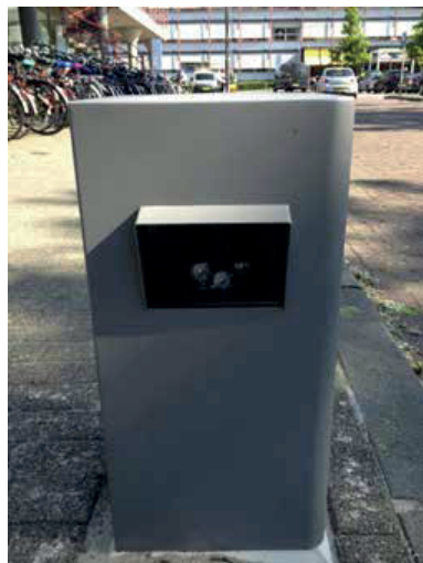
De intelligente camera scant het kenteken.
